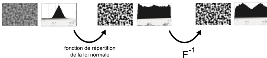
FIGURE 22 – Pipeline de contrôle de l'histogramme d'un bruit de Perlin. La première étape est une normalisation (l'histogramme devient presque plat), et la second modifie les valeurs selon n'importe quelle loi de probabilité.
