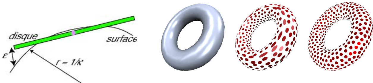
FIG. 1 – À gauche, la surface et un des disques l'approximant (vus en coupe 2D). À droite, un tore et la répartition des 510 ellipsoïdes ou 734 disques le représentant ( \epsilon = 0.2\% dans les deux cas).
