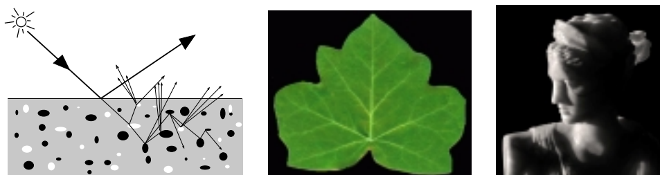
Figure 14 – A gauche : cheminement de la lumière à l'intérieur du matériau. La simulation de ce transport permet une modélisation plus fine de la réflectance du matériau. Au milieu : Rendu d'une feuille prenant en compte la matière interne (Image : Hanrahan, Princeton, Krueger, GNRCCS [HAN 93]). A droite : simulation complète du transport à l'intérieur du matériau, permettant la prise en compte d'effets non locaux (transmission de lumière) (Image : Dorsey, Edelman, Jensen, Legakis, Pedersen, MIT [DOR 99]).
