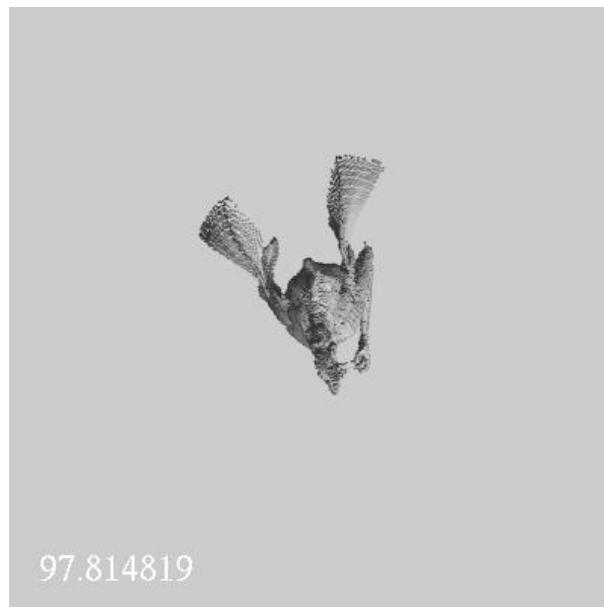
FIG. 6.3 – Le résultat visuel lorsqu'on est trop près du texel et que l'on regarde dans une direction trop oblique
