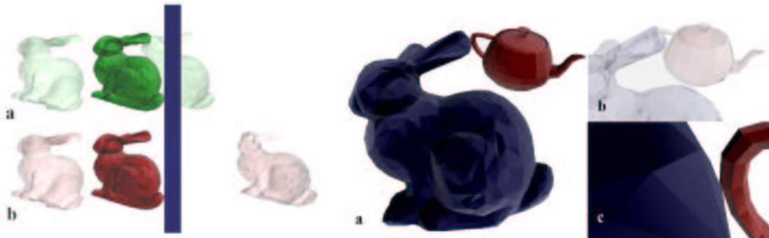
FIG. 7.9 – Avantage de la méthode relativement aux algorithmes discrets. A gauche on peut voir qu’un algorithme discret n’aurait pas détecté la collision (cas b). A droite, l’agrandissement montre la précision de l’algorithme proposé vis-à-vis d’une détection discrète.
