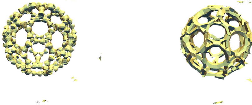
FIG. 2.11: Conservation de la topologie du champ scalaire. À gauche, une isosurface extraite du maillage BuckyBall à haute résolution (1 250 235 tétraèdres). La même isosurface à droite extraite de notre maillage simplifié (7 126 tétraèdres) en n'utilisant que les extrema locaux (hors points selles).
