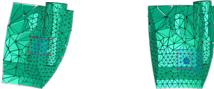
FIG. 2.9: Limitations de la multirésolution basées sur les opérations locales. Ces deux extractions illustrent le rôle des dépendances entre les opérations de décimation. Malgré une zone locale d'intérêt réduite, l'extraction à un haut degré de granularité est faite sur plus de la moitié du maillage afin de garantir la conformité du maillage.
